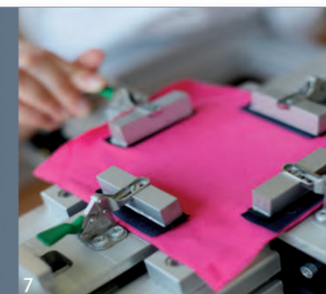
6 通过“马丁代尔磨损测试仪”模拟纺织品的机械负荷。
